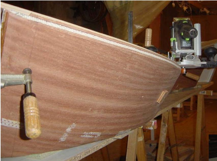
Usinage des angles de corroyage supé-
