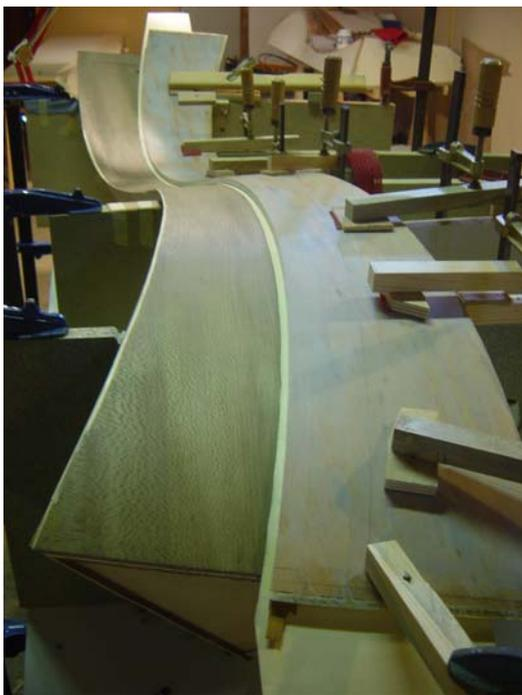
Défonçage et découpage pour la pose des bandes
