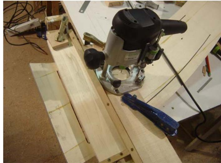
Usinage de l'angle de corroyage supérieure de l'abatant
