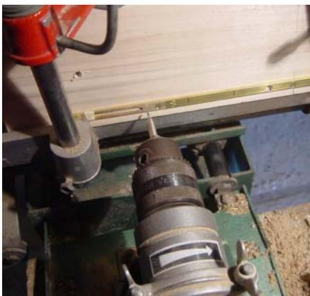
Usinage de la lumière avec l'angle de corroyage
